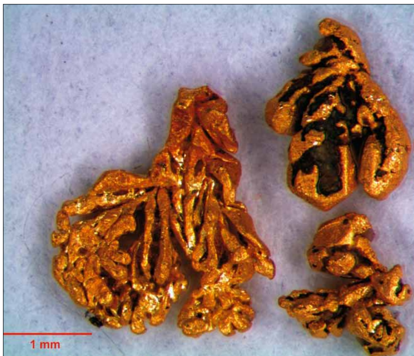
Abb. 8 Seifengold aus dem Sotk mit morphologischen Relikten von dendritischem Wachstum und Verwachsungen mit Gangart (Probe PA 18).
